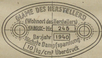
Bild 43. Kesselfabrikschild mit gegossener und geschlagener Beschriftung
