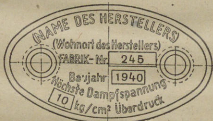
Bild 43. Kesselfabrikschild mit gegossener und geschlagener Beschriftung
